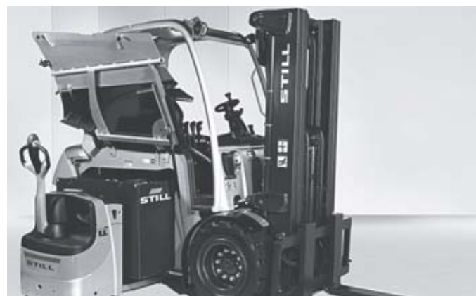
Cambio de la batería lateral sencillo con transpaleta y lecho de batería
