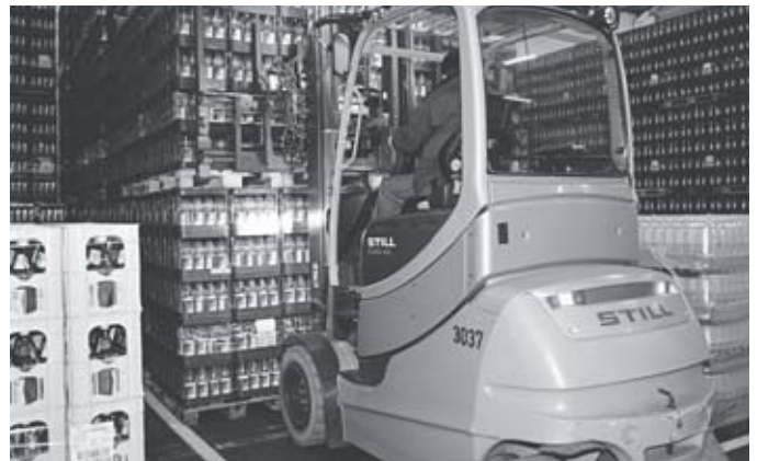
Buena visibilidad de la carga elevada gracias al asiento del conductor más elevado
